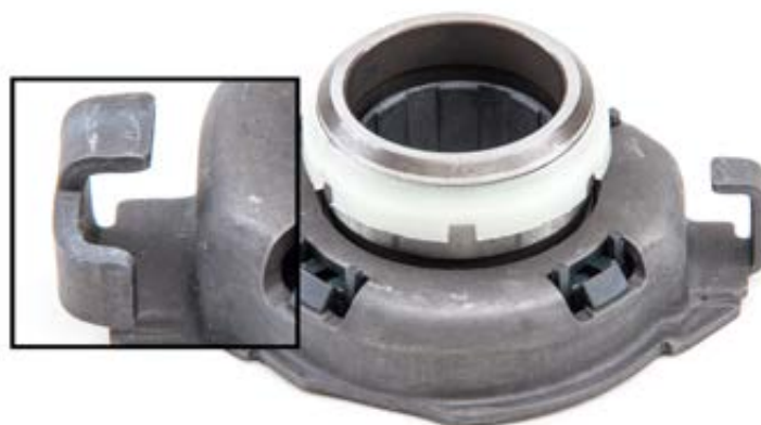
Foto 1: Foto 1. Uszy łożyska oporowego są częścią obudowy
